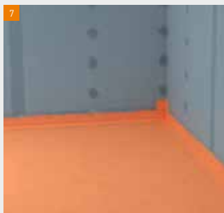
7 Si vous utilisez des Plaques de sol fermacell en fibres-gypse, vous devez appliquer systématiquement une Sous-couche de protection à l'eau fermacell sur toute la surface exposée aux projections d'eau.
